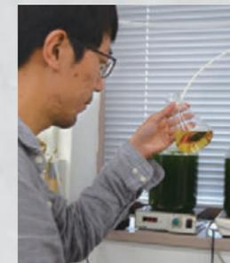
微細藻類からのバイオディーゼル燃料製造実験
