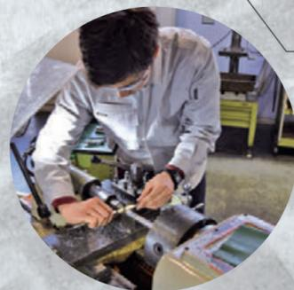
▲ 旋盤を使って小形万力の部品を作っています。
