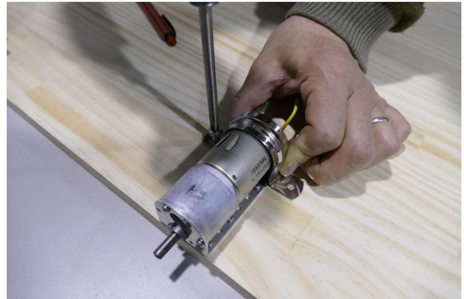
ゴム板の上からモータの後部をサドルバンドを使って板に固定。(サドルバンドのねじ止め)
