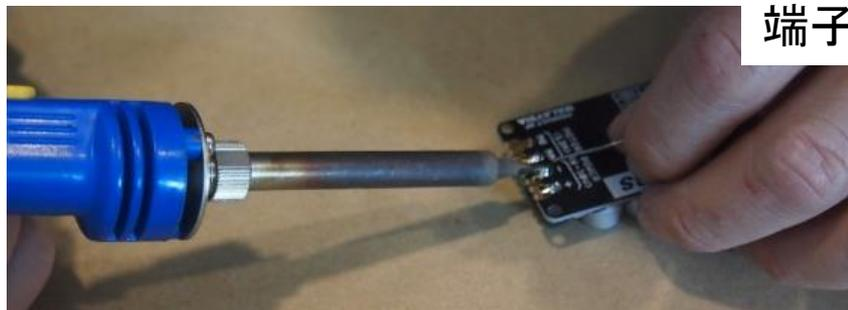
端子台を基盤の穴に差し込んで、モータドライバ基板の裏から半田付けします
