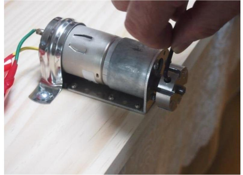
次に、六角レンチの短い方を穴に差し込んで、ねじを回します。「くっくっく」という感じで、中程度の力で締めます。思いっきり締めるとねじ穴が破損します。
