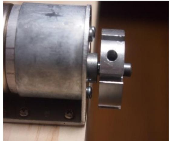
回転軸にアルミの部品を差し込みます。穴の丸いほうがモータ側(内側)になります。軸の平らな部分とアルミ部品の穴の平らな部分を合わせます。
