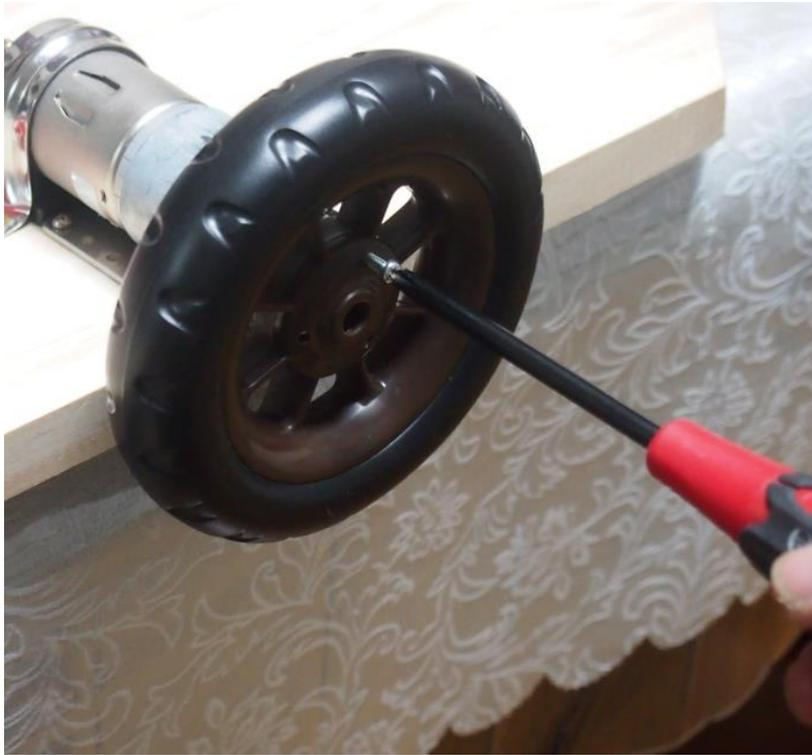
タイヤの中にあるアルミ部品の平らな部分と回転軸の平らな部分を合わせて、タイヤを回転軸に差し込んで下さい。ねじ(M3×30)にナイロンワッシャーを入れて、タイヤをねじ止めて下さい。
