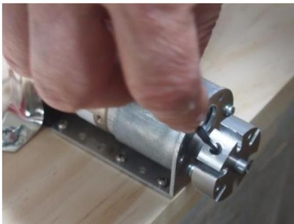
六角穴付きねじを穴に差し込んで回していきます。コツンと中のねじに当たったら止めます。
